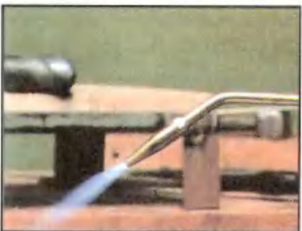
Нормальное (восстановительное) пламя: длина внутреннего конуса пламени белого цвета должна быть в пределах 8–10 мм. Это оптимальная настройка при соотношении расхода кислорода к ацетилену b=1,1-1,3 .
