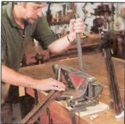
Чтобы угловые соединения выглядели «бесшовными», запиленные кромки тщательно подгоняют.
