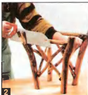
2 Сгнившие участки древесины необходимо аккуратно вырезать.
