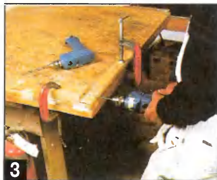
3 Отверстие под шпильку удобно сверлить закрепив деталь на верстаке и подложив доску для бокового упора под сверло.
