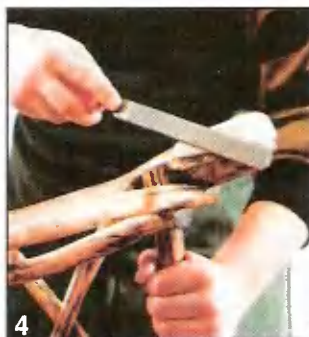
4 После высыхания клея струбцины снимают и доводят вставку стамеской и рашпилем до формы ножки.
