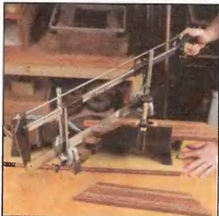
Запил багета «на ус» мелкозубой пилой в стусле дает хорошие результаты.
