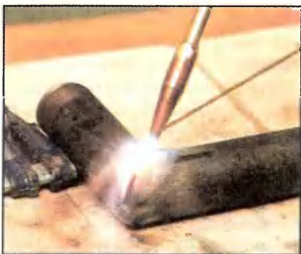
Прогрев: появление в зоне шва равномерной светло-желтой окраски означает, что требуемая точка плавления достигнута.
