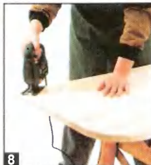
8 Скругления делают электролобзиком, а края обрабатывают шкуркой средней зернистости.
