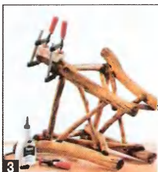
3 На вырезанные места вклеивают вставки по возможности из той же породы дерева.
