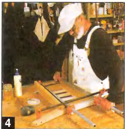
4 Детали боковин при склеивании зажимают струбцинами.
