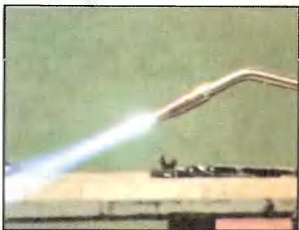
Пламя слишком большой длины: сварочный шов «обугливается», т.е. науглероживается. С помощью маховичка надо уменьшить подачу ацетилена.
