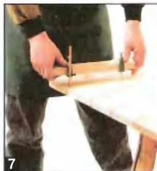
7 Углы собранной новой столешницы надо скруглить.
