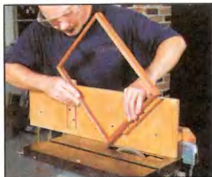
С помощью такого приспособления пазы под шпонки в углах готовой рамки делают циркульной пилой.
