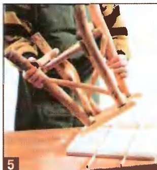
5 Новое сиденье собирают из досок и крепят к ножкам двумя тонкими брусками.
