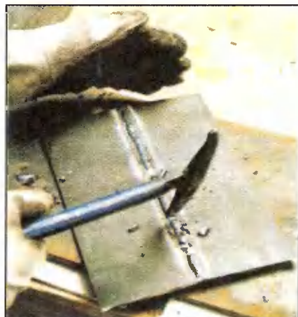
С застывшего шва шлак предварительно удаляют специальным молотком. Не сомневайтесь, соединение уже способно воспринимать нагрузки!
