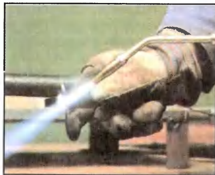
Зажигание: сначала нужно осторожно открыть кислородный вентиль на ручке, затем — ацетиленовый, после чего можно зажигать.
