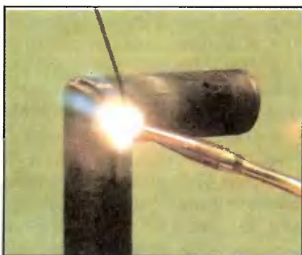
Для заполнения шва в зону расплава вводят присадочный металл в виде прутка или проволоки.
