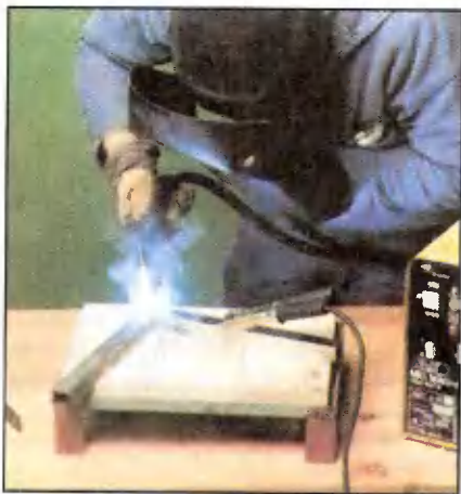
Подачу электродной проволоки через насадку регулирует электроника, а чистоту шва обеспечивает защитный газ.
