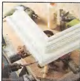
Зажав склеиваемые детали в специальном угловом зажиме, соединение усиливают шурупами, заворачиваемыми во внешние кромки багета.
