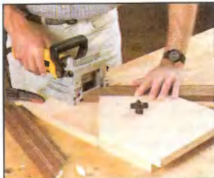
Пазы под закладные шпонки можно сделать плоской дисковой фрезой.
