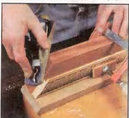
Срез можно обработать на чисто торцевым рубанком, зажав багет вместе с шаблоном.
