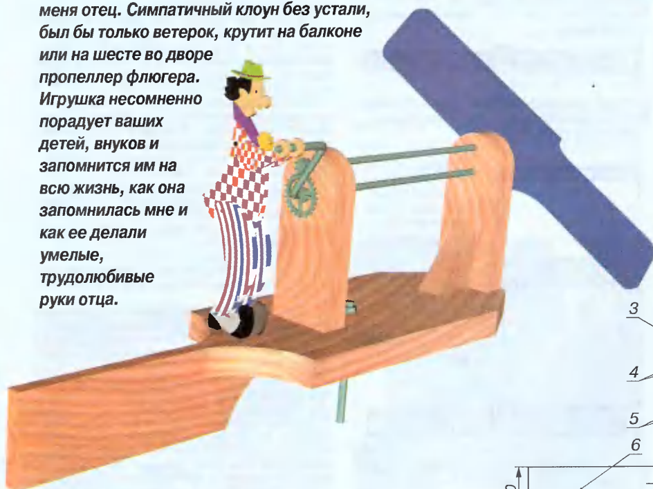
Флюгер: 1 — пропеллер; 2 — кривошип; 3, 4, 5 — детали фигурки; 6 — основание.
